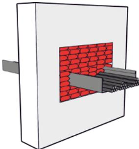
Füllen Sie den restlichen Teil der Aussparung mit RPS-T Brandschutzkissen auf, bis die gesamte Aussparung abgedichtet ist. Auch hierbei müssen die RPS-T Brandschutzkissen so straff wie möglich eingesetzt werden, sodass keine Nähte entstehen.
