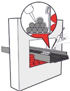
Tragen Sie dort, wo die RPS-T Brandschutzkissen hinkommen, zwischen den Kabeln und in der Profilierung der Kabelführung selbst über eine Breite von ca. 200 mm RPI-S Füllstoff auf.
