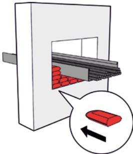
Setzen Sie die RPS-T Brandschutzkissen in die Aussparung, sodass die Längsseite der RPS-T Brandschutzkissen parallel zur Kabelführung verläuft.
