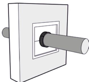
4. Finissez l'espace entre le mur et le Manchon coupe-feu RPI-P à l'aide du Système d'étanchéité RPI-S (voir manuel de montage Système d'étanchéité RPI-S).
