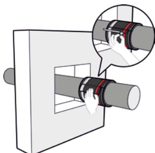
2. Détachez le film dorsal de l'autocollant de montage et collez l'autocollant de montage sur le Manchon coupe-feu RPI-P, pour que le Manchon coupe-feu RPI-P entoure et serre le tuyau.
