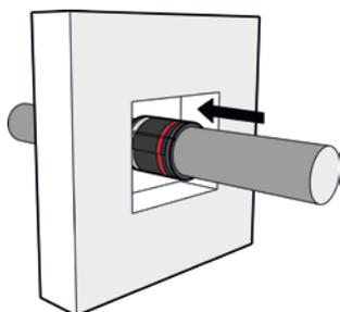
3. Glissez le Manchon coupe-feu RPI-P sur le tuyau, pour que le milieu du Manchon coupe-feu RPI-P ressorte au milieu de la construction ignifuge.
