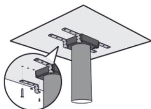
Eine RPI-P Brandschutzmanschette muss immer an vier Punkten befestigt sein. Bei der Verwendung von Bügeln müssen zwei Seiten der Brandschutzmanschette mit mindestens zwei Bügeln ausgestattet sein. Schrauben Sie die Befestigungsbügel mit selbstbohrenden Schrauben an der RPI-P Brandschutzmanschette fest.
