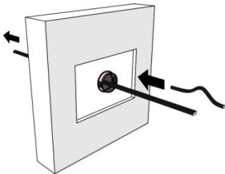
Führen Sie die Kabel durch die Fräse.
