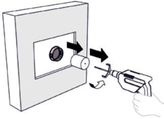
Entfernen Sie den ausgesägten Zylinder (Abdichtungsplatte).
