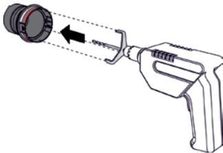
Befestigen Sie den Adapter an der Fräse.
