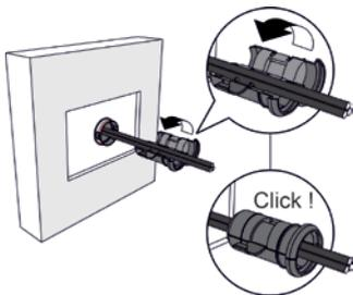
Öffnen Sie den Kern des RPI-E Flex tube.
