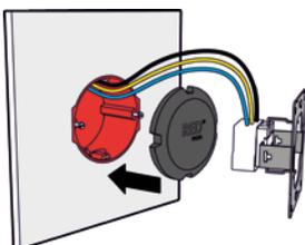
Setzen Sie den RPI-E Connection box stop ○ gegen die Rückwand der Wandsteckdose.
