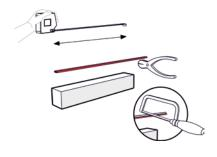
Messen Sie zunächst, wie lang das RPI-D Tordichtungsprofil, Tordichtungsprofil PVC, Tordichtungsprofil PVC mit Bürste sein muss und passen Sie die Länge gegebenenfalls an.
