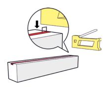
Befestigen Sie das Tordichtungsprofil mit Nieten an mehreren Punkten.
