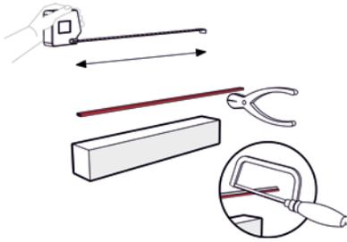
Mesurez d'abord la longueur que doit avoir la Bande de porte RPI-D, la Bande de porte pvc RPI-D, la Bande de porte avec brosse RPI-D et ajustez éventuellement la longueur.
