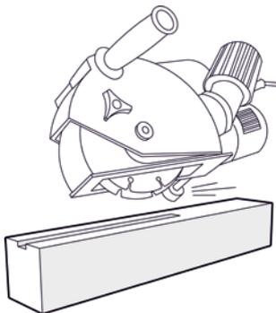
Fraisez éventuellement une rainure dans la porte, le châssis ou la fenêtre.
