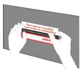
Entfernen Sie einen Teil der Folie von der Rückseite des RPI-S Dichtungsstickers und bringen Sie den Sticker an der richtigen Stelle an, reiben Sie den Teil ohne Rückenfolie gut fest.
