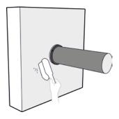
Für eine gute Haftung des RPI-S Dichtungsstickers befreien Sie den Untergrund von Schmutz, Nässe und Staub. Achten Sie darauf, dass beim Anbringen des Stickers die Klebeschicht nicht berührt wird.
